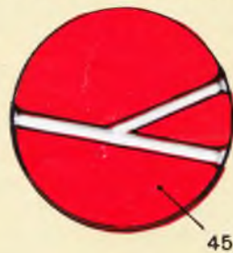
РАСПОЛОЖЕНИЕ МАСЛЯНЫХ КАНАЛОВ В СРЕДНЕЙ ОПОРНОЙ ШЕЙКЕ
